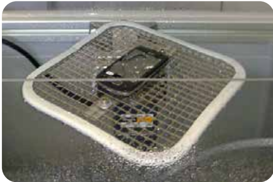
Rakapól símanna var kannað með sértöku tæki sem líkir eftir rigningu.
